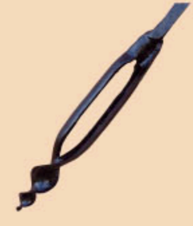
Handbohrer zum Aufspüren der Farberde
